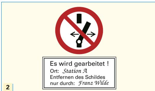
Das Verbotsschild an der Freischaltstelle muss immer und unter allen Umständen angebracht werden. Auch innerhalb von abgeschlossenen elektrischen Betriebsstätten oder innerhalb von verschlossenen Schaltschränken. Es gibt für diese Regel keine Ausnahme.
