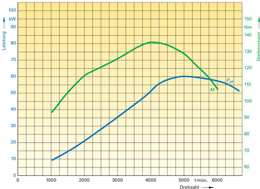
Zeichnen Sie den elastischen Bereich des am Prüfstand getesteten Motors ein.
