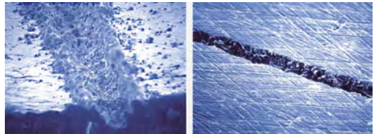
2 Oberflächenstruktur nach Laserbehandlung (links) und anschließendem Honen (rechts)
