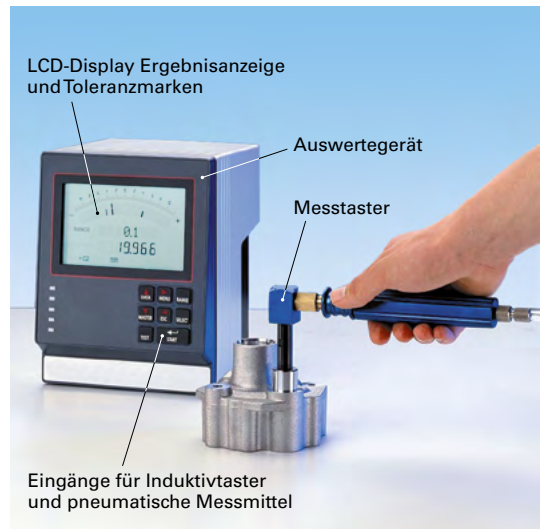
2 Elektronisches Messgerät mit induktivem Messtaster
